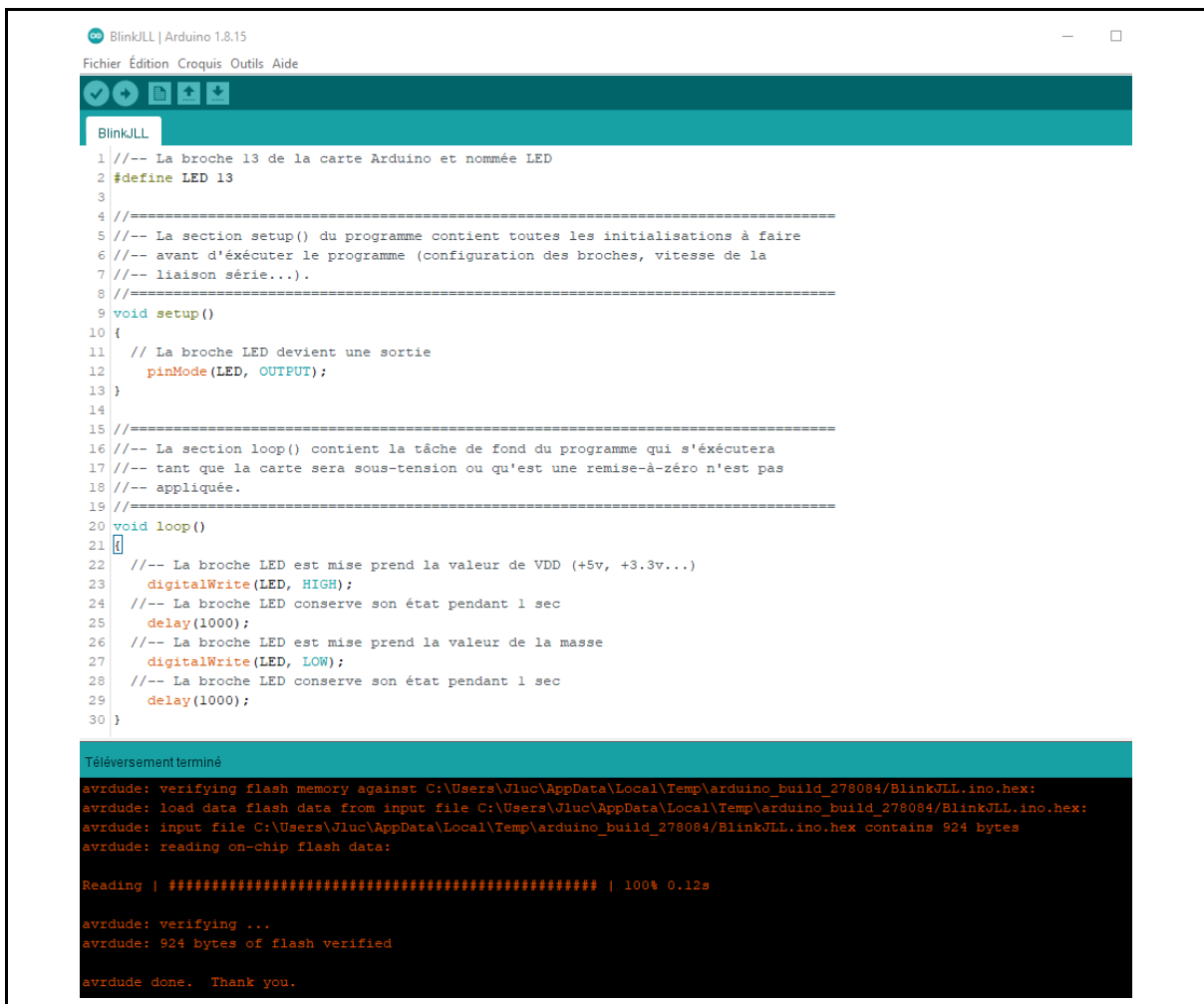
Figure 11. Exemple de programme de test “blink”.
